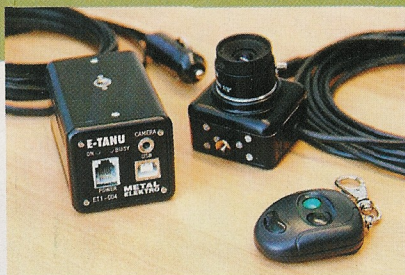
E-tanú-egységek: kamera, lassulásmérő és adatrögzítő továbbá a kézi indító
