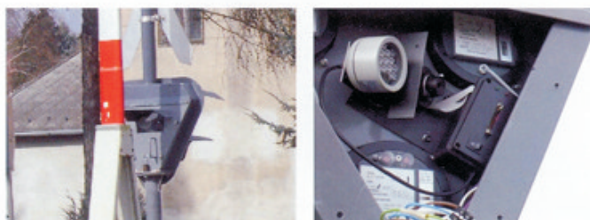
1. kép. Optikai megfigyelő készülék beépítve (két nézetben)
